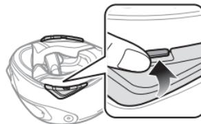
2. 壓下凸出片同時將維護工具插入凹槽，並用推的方式將側蓋卸下。
